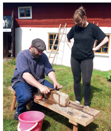
Mattias Helje går igenom de liar deltagarna tagit med sig (överst). Det finns olika sätt att slipa en lie. Kristoffer Skogsberg visar Alva Virén hur man kan göra med en fyrkantig slipsten. Göran Ehn arbetar med den vanliga roterande.
