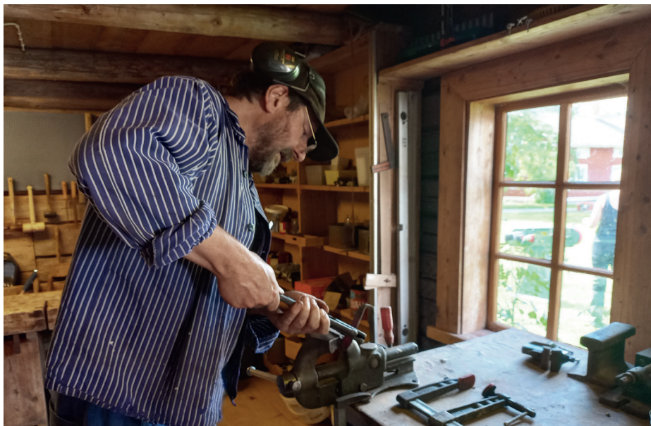
Mattias Helje kröker till ett lieblad som värmts upp på den mobila ässjan, bilden ovan. På bilden nedan blir han fotograferad av P4 Gävleborg, som gjorde reportage från liekursen.
